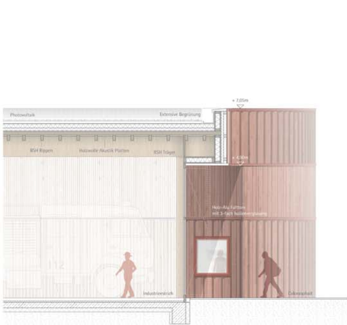
FASSADENSCHNITT FEUERWEHR M 1:50
