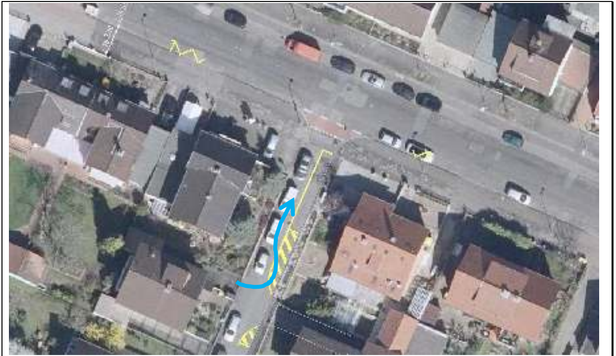
Abbildung 8: Einmündung „Große Ausdauer“ / „Speckweg“ mit erforderlichen Sperrflächen zur Befahrbarkeit der Grundstücke und Kennzeichnung der Haltverbotsbereiche um die Einmündung auf dem Speckweg (bei 50 km/h zulässige Höchstgeschwindigkeit). Genaue Lage und Abmessungen sind im Detail zu prüfen.
