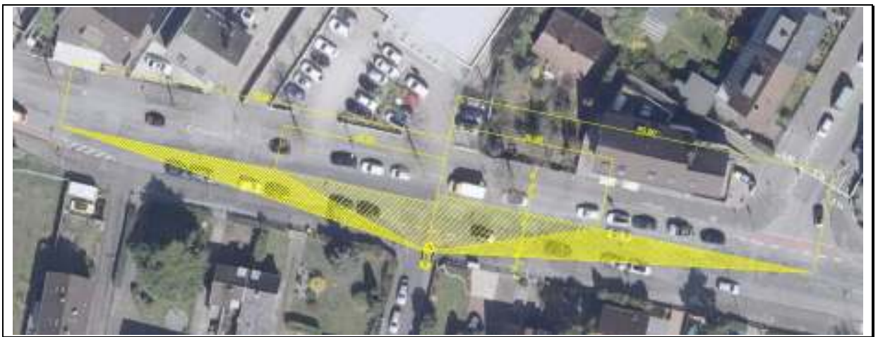
Abbildung 7: Einmündung „Kleiner Anfang“ / „Speckweg“ mit Darstellung der Sichtfelder (laut Regelwerk (30 m bei 30 km/h und 70 m bei 50 km/h zulässiger Höchstgeschwindigkeit) [Luftbild: Stadt Mannheim]
